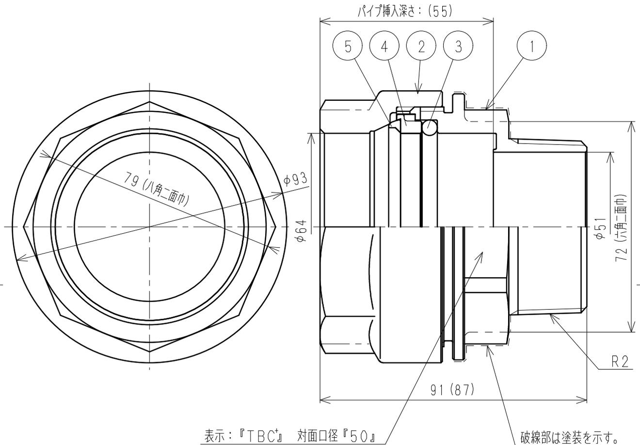
注) カッコ寸法は、ナットを締め付けた時の寸法を示す。
