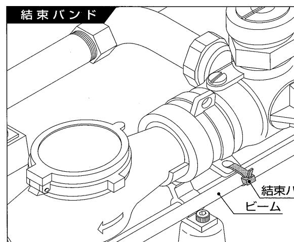
5. ユニット及びメータ接続部からの漏水がないことを確認した後、結束バンド(東京都水道局支給品)でメータハンドルとビームを結束し、メータハンドルが回転しないようにしてください。
