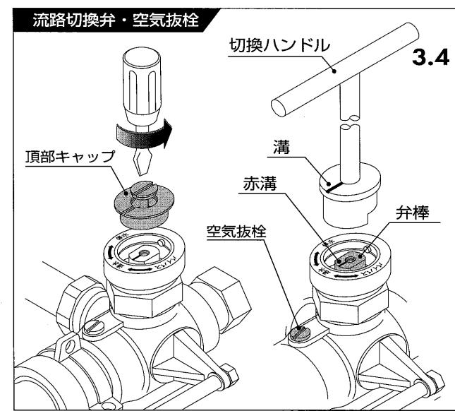
3. 流路切換弁の操作にあたっては頂部キャップをマイナス・ドライバー等で外し、切换ハンドルの溝を弁棒上面の赤溝と向きを合わせて流路切換弁の上部に差し込み、切换操作を行ってください。
