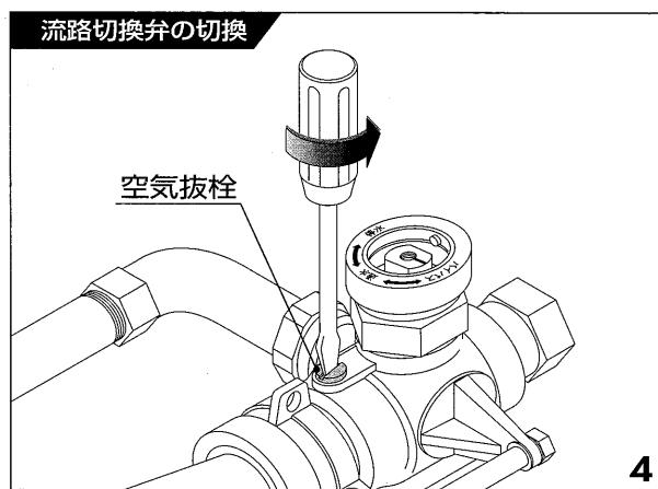
4. 空気抜栓を緩め空気抜きを行い、メータ部分の内圧を抜いて下さい。内圧が抜け次第、空気抜栓を締めてください。
