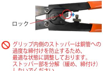
グリップ内側のストッパーは銅管への過度な締付けを防止するため、最適な状態に調整しております。ストッパー部を分解(緩め、締付け)しないでください。
