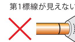
**⚠️** 第1標線と継手端面に 2mm 以上の隙間がある場合は挿入不足です。
