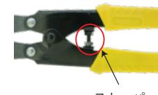
⚠️ 楕円矯正は継手挿入部のみ行うため、銅管を矯正工具で挟んだ状態で管軸方向にスライドさせないでください。スライドさせることにより管に傷が発生し、漏れの原因となります。
