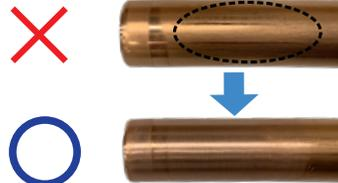
(★)ただし、矯正工具による【以下の写真(a)】管端および管端から50mmを超える位置についた擦れ痕や【以下の写真(b)】管切断時のローラーカッターによる擦れ痕は、継手の性能に影響しません。
