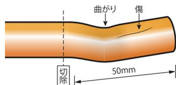
・管端から50mmの範囲で管に傷・曲がり・扁平・熱劣化・内外面への異物付着がある場合は、その箇所を切除してください。管を切断した場合、再度保温材を切除してください。
